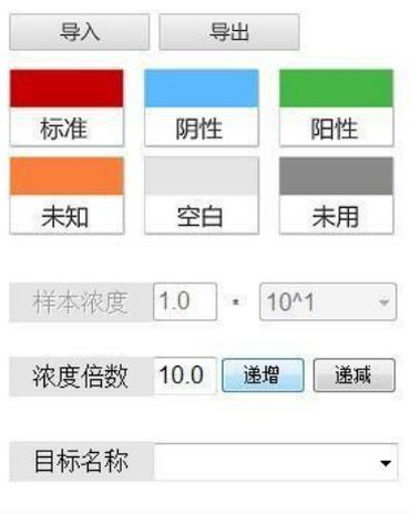
在操作过程中，孔位分布图右侧为“试剂参数设置”，根据试剂属性，用户进行手动设置。包括：试剂属性，样本浓度，浓度倍数，通道，基因名称标定，样本名称标定，管家基因设置，标准样本设置等设置。
