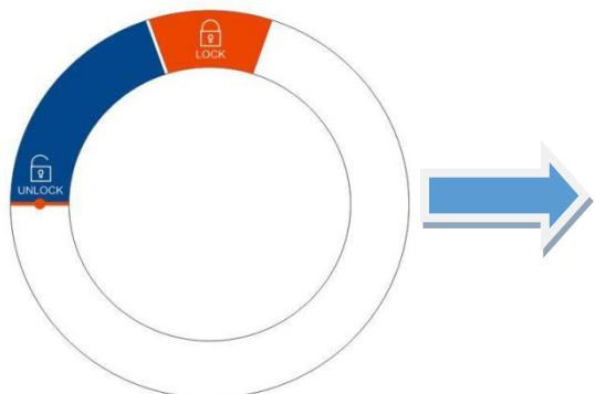
先将旋钮刻度指示对准UNLOCK点时，向后滑动热盖，把待检测样本试剂放入96孔仪器模块中，再将热盖向前滑动关闭，然后顺时针旋转旋钮，旋钮旋转到合适位置，可运行程序进行试验。建议旋钮刻度对准LOCK区域。
